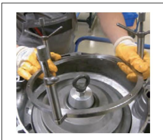
6. 拆除离合器盖压紧工具
