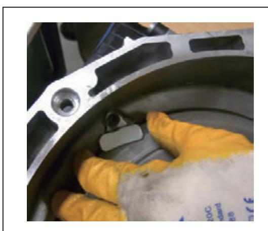
7. 使用新螺栓定位新压片固定好离合器盖
