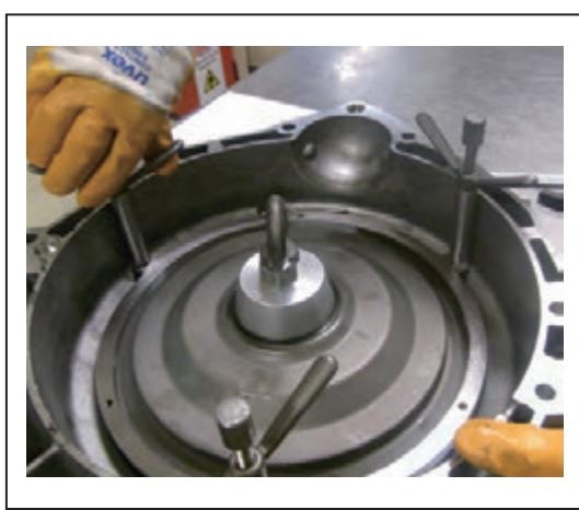
5. 逐个旋扭翼形螺帽下压离合器盖，直至最终到位
