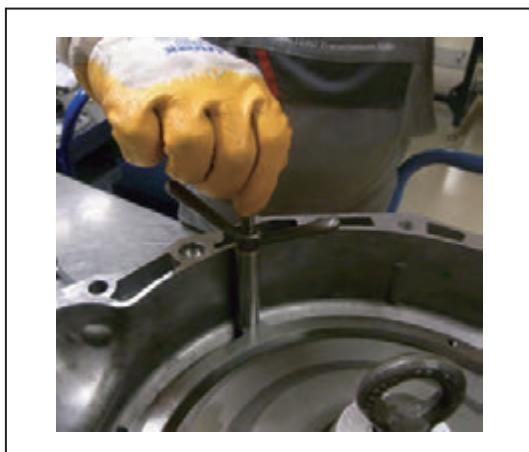
4. 手动拧紧压片螺栓来固定压紧工具
