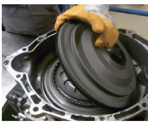
9. 使用变速箱机油润滑离合器主毂及外部密封表面
